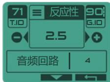
**DEUS II** 是一个快速和具有选择性的探测器！反应性是一个至关重要的设定，它决定着探测器的性能，分析被探测到的金属物体信号的速度以及对于位置比较靠近的两种金属物体的区分能力。如果土壤中含有大量的铁，热岩石或者其他矿化元素，那么对于土壤的穿透性会降低。这种情况下，您可以选择高反应性，这样可以更快速地分析金属信号。另一方面，如果土壤是干净的，最好也将反应性调节降低，扫描速度也放更慢一些，这样可以使得探测器对于较深的群聚金属物有更高的灵敏度，并且对于土壤会有更强的穿透性。在海滩上，由于目标通常彼此远离，因此低反应性水平（如0或1）将非常有效。但是，如果你遇到棘手的情况，例如由磁性黑砂构成的污染海滩或盐度可变的海滩，则将反应性增加到2.5或3，从而变得更具选择性和更稳定，这将使你更容易分析目标。
