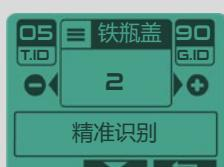
瓶盖排除功能有效地排除了生锈的啤酒瓶盖和汽水瓶盖。你可以确保在海滩、公园和污染区激活它。
