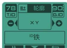
目标信号显示为示波器。XY屏幕提供视觉帮助，并可提高对困难目标的识别能力。例如：识别没有精确特征的目标（一些铁质物品、易拉罐等）。
