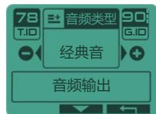
**DEUS II** 为您提供广泛的声音和声音偏移选择。根据您的喜好和周围环境，您可以使用完全不同的音频类型。例如，某些音频类型将通过软化干扰引起的低信号更好地适应棘手的污染地面，而其他音频类型将通过根据目标深度或大小混合不同声音的动态比例更好地识别目标距离。
