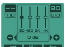
除了简单的低/高音频设置外，均衡器还可以在四个频段上校正扬声器和耳机的声音，使其与您的听力偏好相匹配。因此，您可以将低音设置为150 Hz左右，中低音设置为450 Hz左右，中高音设置为2000 Hz左右，高音设置为4000 Hz左右。
