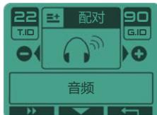
**自动:** 如果没有无线耳机配对, 请在启动遥控器时选择无线耳机图标。按耳机模块上的 键八秒钟遥控器将邀请您配对。
