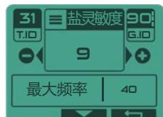
除常规灵敏度设置外，«盐灵敏度»设置还具有减少通常与海水有关的虚假信号的优点，而常规灵敏度作用于所有目标和所有信号。在搜索潮湿海滩或海底冲浪时，始终优先使用盐灵敏度设置，而不是常规灵敏度。常规灵敏度应当是机器受到来自电磁干扰 (EMI) 的情况下使用的。
