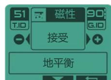
在磁性地面（如黑砂）探测时，深层目标可能会因为它们的值与土壤值相似而被掩盖。磁性地面设置允许您接受由地面、铁氧体、陨石以及通常被掩盖的远处目标产生的中等色调。
