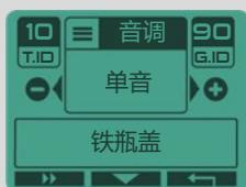
Pitch沥青模式不同于其他的模式，它不会顾及金属目标的传导性：信号的长度生成的音频信号随着振幅和高度（频率）变化而变化。目标的深度越深，生成的就是低程度音频，声音比较微弱。越近的金属目标，生成的就是高程度音频，声音比较强。相反，在识别阈值以下，目标离探测盘越近，声音就越低沉。音高模式可以给出“特色”的信号，可以用来定位目标。这也使得探测器似乎有了更多的反应。但是，它对于探测器的反应性没有影响，只是影响音频。
