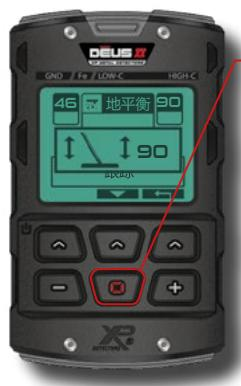
在任何菜单下, 你可以随时通过按住 按键并且同时对着地面土壤上下抽送探测盘直到地面音频信号减弱并且数值稳定。
