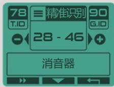
这个高级功能可以让您自由选择单项排除的金属数值区间，数值区间可精准到某一个数值，而不仅仅是一个数值区间。可以拓宽数值区间也可以缩小数值区间。例如您不想要探测的金属的数值在28-46，您可以将阈值1的数值选择到28，将阈值2的数值选择到46.或者您不想要探测的金属数值在50-51，您可以将阈值1的数值调节到50，将阈值2的数值调节到51.
