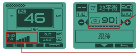
● 矿化强度.读条值越高, 土壤的矿化程度就越高。将探测盘对着地面, 进行上下抽送看下矿化的强度。
