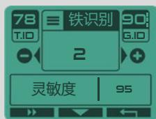
程序8和程序9使用的是一个不同的识别方式，称之为 IAR (铁振幅排除)。根据铁金属距离探测盘距离来排除铁金属目标。
