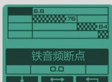
在多音调模式下，按住 键直至出现“接地/铁质断裂”音调，然后将其从 0.0 调整到 -6.4。一些接近接地的铁质元素可能会部分落入负 ID 区域，导致声音中断。
