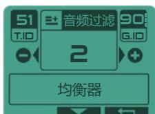
该功能用于过滤音频，产生更柔和、更流畅的声音，尤其是当目标处于检测极限时。在深度处，信号将不那么刺痒。在某些情况下，音频滤波器可以获得一点额外的深度。
