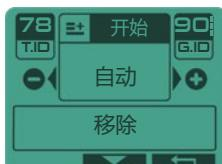
**自动:** XP 无线耳机与遥控器配对后自动打开/关闭。
