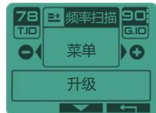
此功能激活检测频率的自动扫描，并在每次节目更改或单声道节目中的每次频率更改时指示干扰最小的清晰频道。频率扫描在**DEUS II**上速度特别快，但会使更改程序时导航速度降低2秒。
