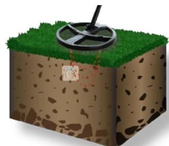
将探测盘放置在没有金属的位置，离地面2-5公分，然后按 精准定位键校准阈值。
