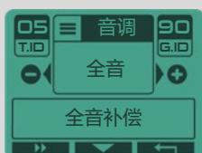
全音识别模式会给每一个金属目标代码生成略微不同的音调。金属目标的传导性越高，ID数值就越高，音调就越高。
