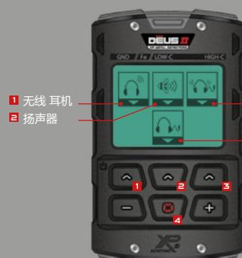
**3** WS6和DEUS II遥控主机匹配之后会随着遥控主机开机自动开机，如果没有匹配则需要按(-)按键开机
