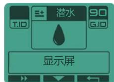
在深度潜水时，水压可能会压缩遥控器上的按键。激活此模式可在到达大约8到10米处时将键盘锁定在潜水模式。这将确保触摸按键不会在深度上中断程序。要禁用此模式，请依次按左键、中键和右键。
